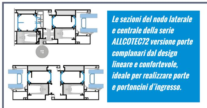
*Le sezioni del nodo laterale e centrale della serie ALLCOTE72 versione porte complanari dal design lineare e confortevole, ideale per realizzare porte e portoncini d'ingresso.*
